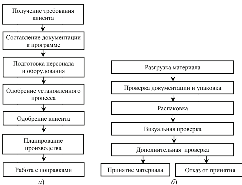
Рис. 3. Карта процесса второго уровня в организации СЕІВА (начало): а – сборка; б – получение материала
