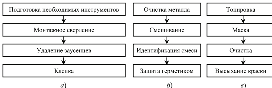
Рис. 4. Карта процесса третьего уровня в организации СЕИВА: а – сборка; б – герметизация; в – покраска
