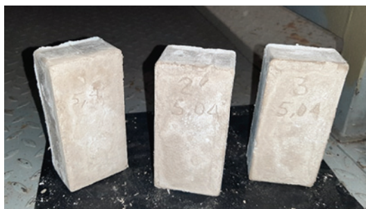
Рис. 3. Образцы геополимера, приготовленные для испытания на растяжение при изгибе
