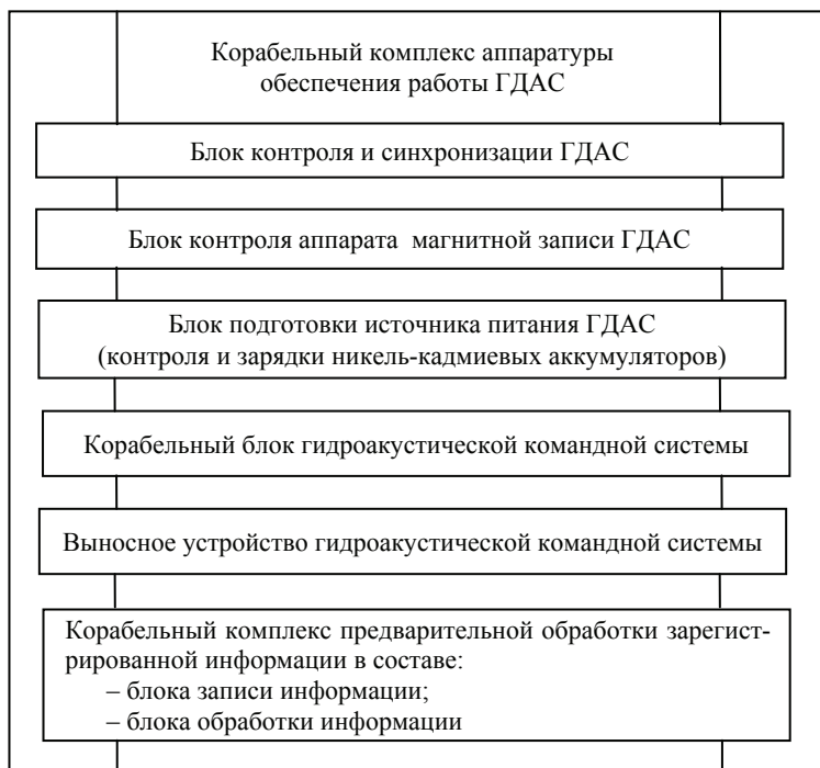
Рис. 5. Состав комплекса ГДАС серии «Монитор»
