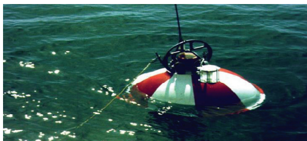
Рис. 4. Глубоководные донные автономные станции серии «Монитор» с комплектом гидрофизических датчиков после всплытия на поверхность моря
