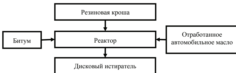
Рис. 3. Схема установки измельчения девулканизированной резиновой крошки
