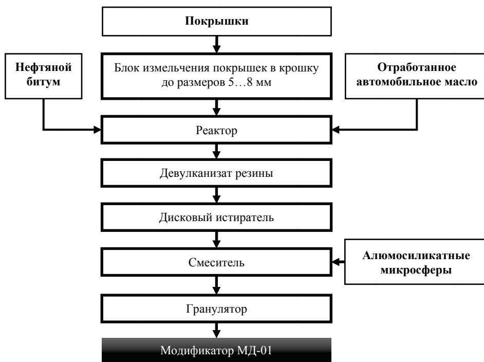
Рис. 1. Технологическая схема получения модификатора МД-01
