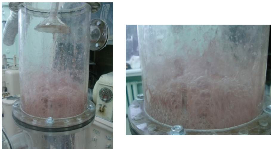
Рис. 2. Улов частиц красного фосфора на лабораторной установке пенной фильтрации
