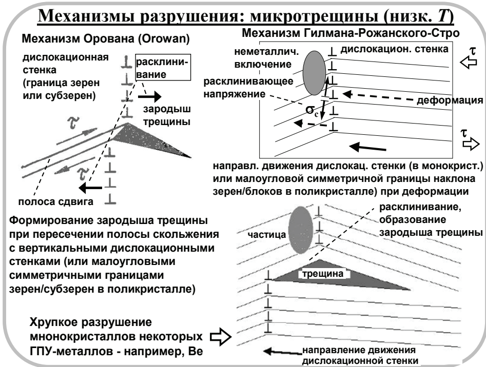
Рис. 3. Некоторые механизмы формирования микротрещин
