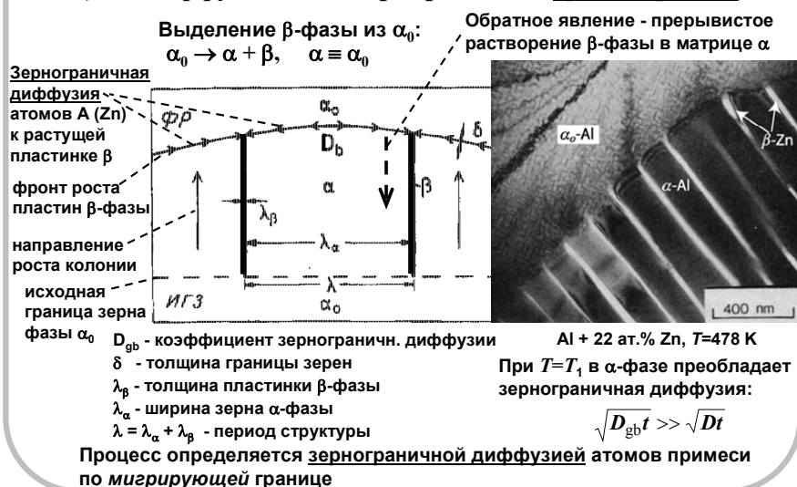
Рис. 7. Механизм прерывистого распада твердого раствора
