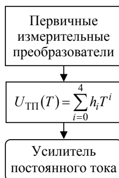
Рис. 5. Структура фреймовой модели блока первичных преобразователей ИИС
