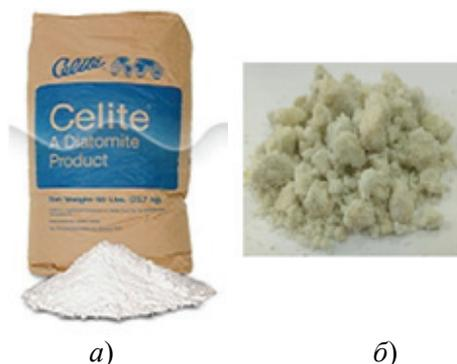
Рис. 2. Чистый порошкообразный минерал – диатомит (а) и отработанный кизельгуровый шлам (б)
