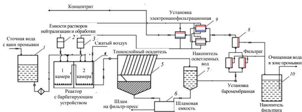
Рис. 1. Схема очистки сточных вод от ионов тяжелых металлов:
