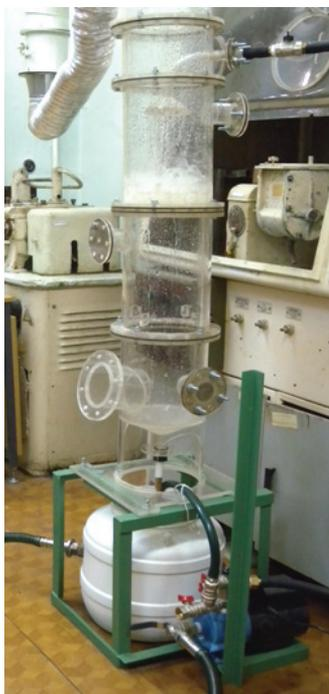
**Рис. 1. Лабораторная установка пенной газоочистки в рабочем режиме исследований**
