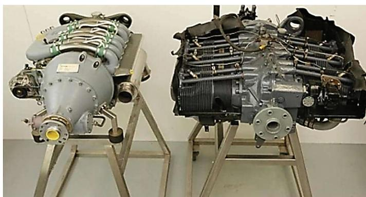
**Рис. 2. Двигатель фирмы MISTRAL (слева) в сравнении с 6-цилиндровым поршневым двигателем**
