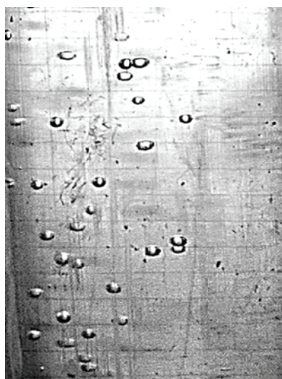
Рис. 2. Фотография пузырьков воздуха во флотационной колонне
