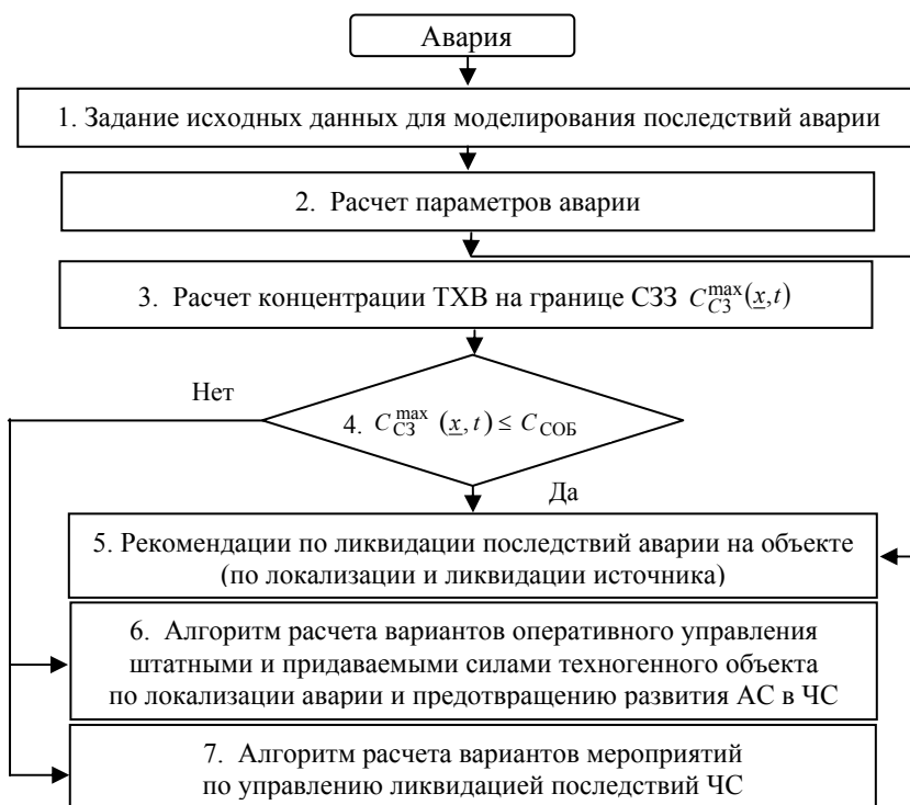
Рис. 1. Общий алгоритм поддержки принятия решений при возникновении аварий на техногенном объекте [7]
