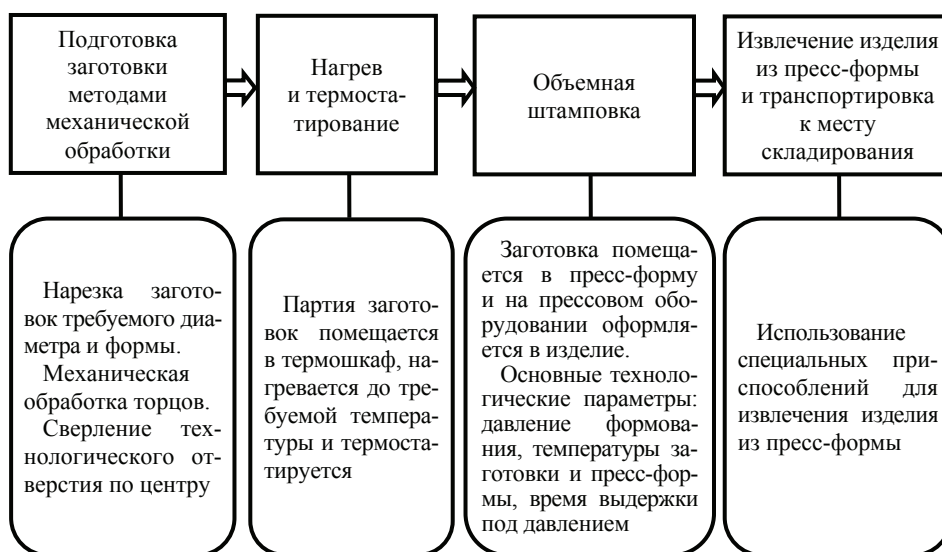
Структурная схема технологического процесса твердофазной объемной штамповки изделий из полимерных материалов
