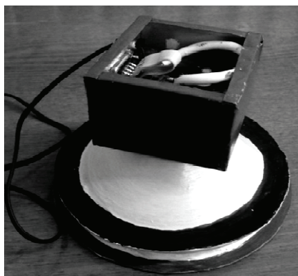
Рис. 1. Общий вид комплексированной приемно-передающей апертурной антенны со снятой крышкой генератора
