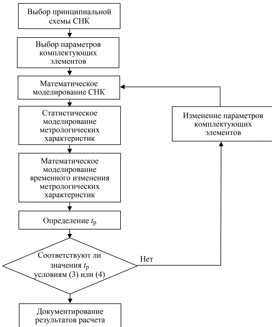
Рис. 1. Схема решения задачи обеспечения требуемой величины метрологического ресурса СНК
