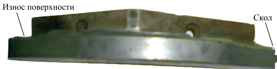
Рис. 1. Дефекты на копирах до модернизации
