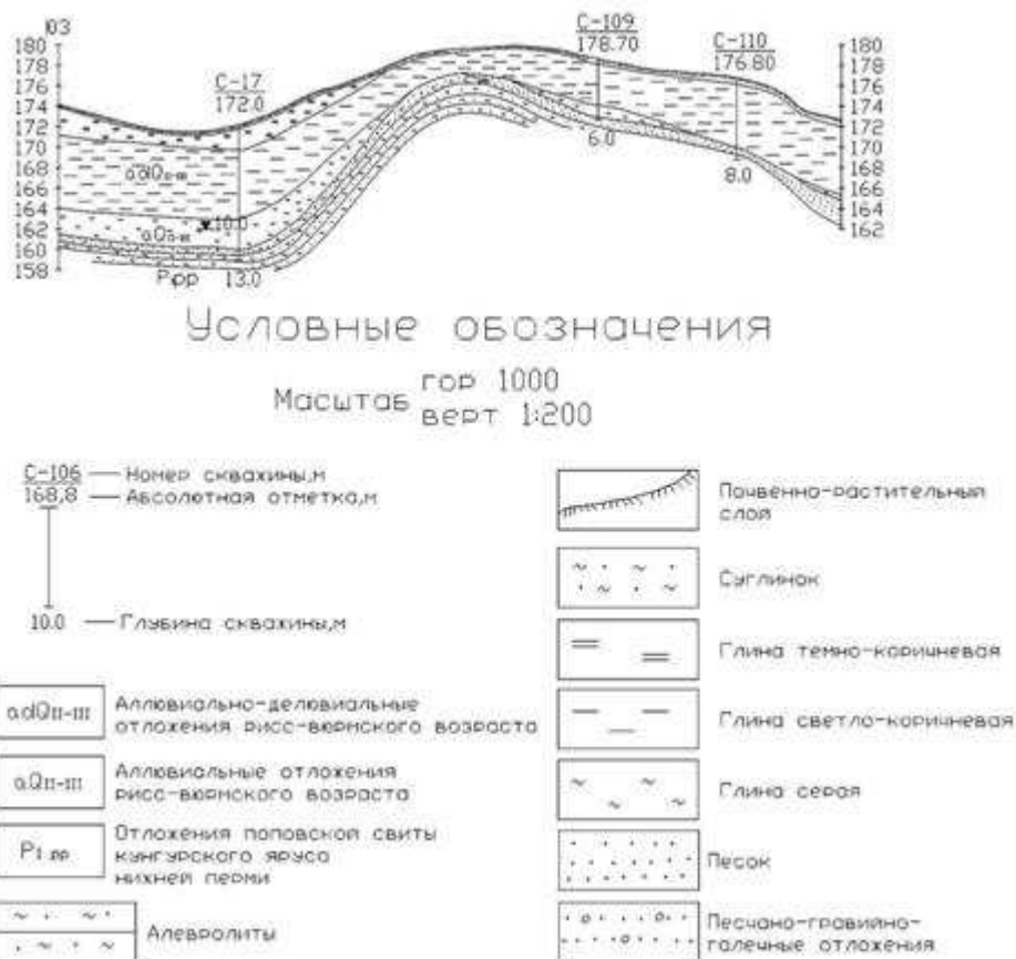
Рис. 3. Типовой геологический разрез месторождения кирпичных глин
