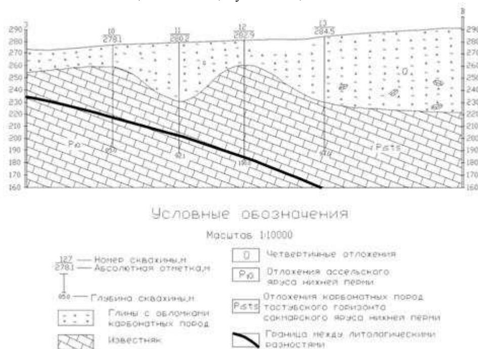
Рис. 1. Типовой геологический разрез месторождения известняков
