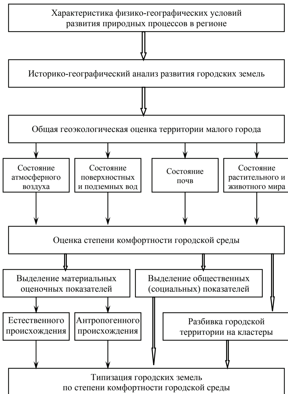
Рис. 1. Алгоритм геоэкологической оценки городских земель и их типизации по степени комфортности городской среды
