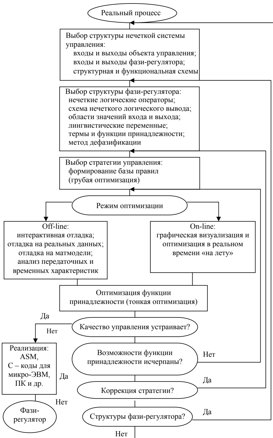
Рис. 1. Алгоритм действия нечеткого регулятора
