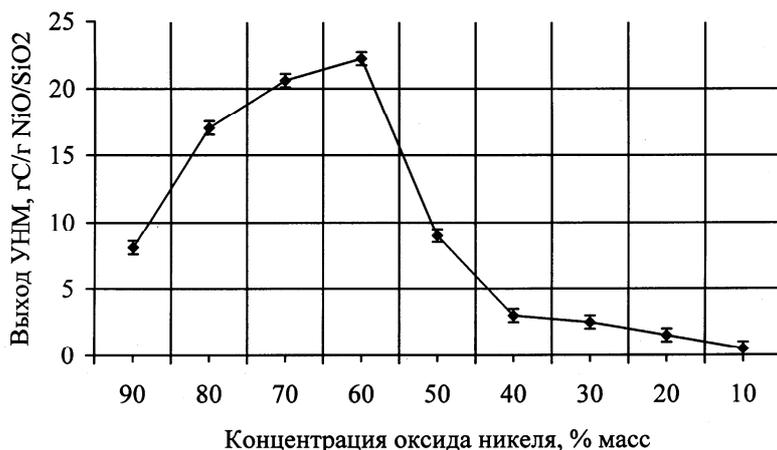
**Рис. 1** Зависимость выхода УНМ от соотношения компонентов никель-кремниевых каталитических систем
